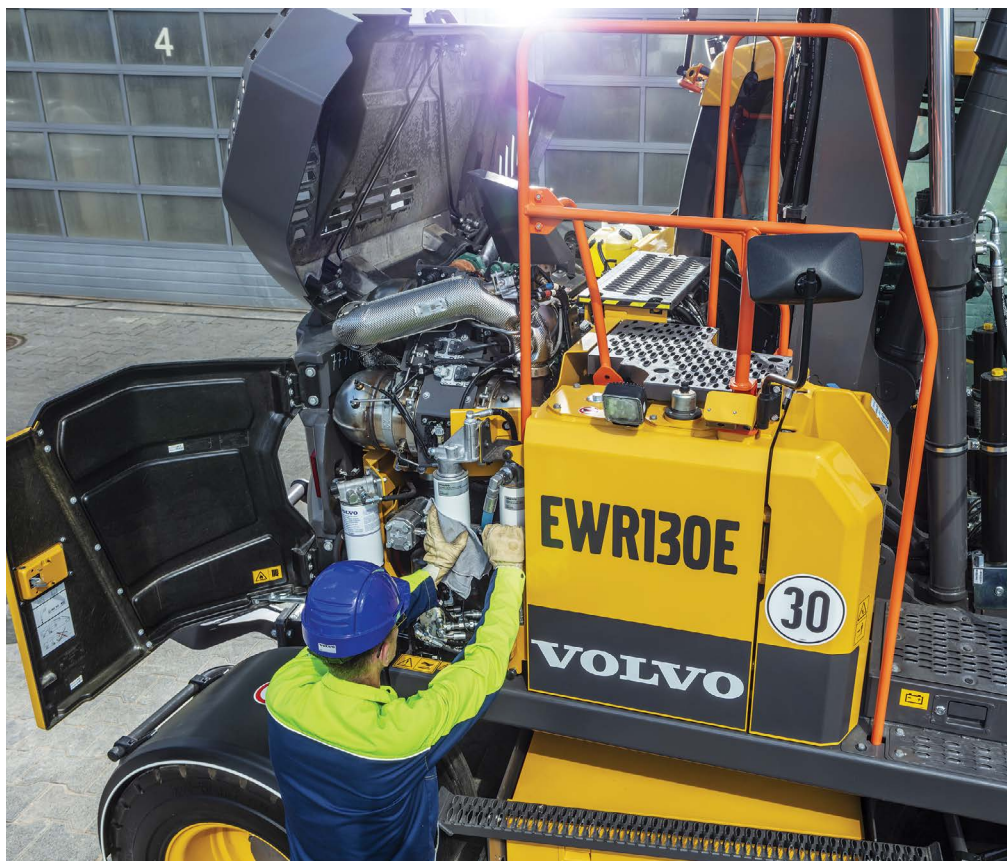
Obr.: U nového Volva jsou přístupové servisní body sdružené do logických celků a hlavně – jsou dosažitelné ze země.
